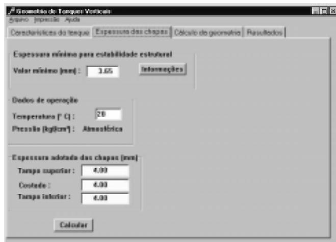
Figura 3 — Espessura das chapas utilizadas na fabricação do tanque atmosférico.
