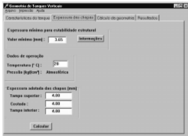
Figura 3 — Espessura das chapas utilizadas na fabricação do tanque atmosférico.
