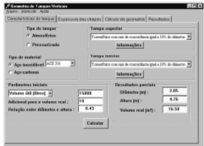
Figura 2 — Características do tanque para cálculo da geometria do tanque vertical.
